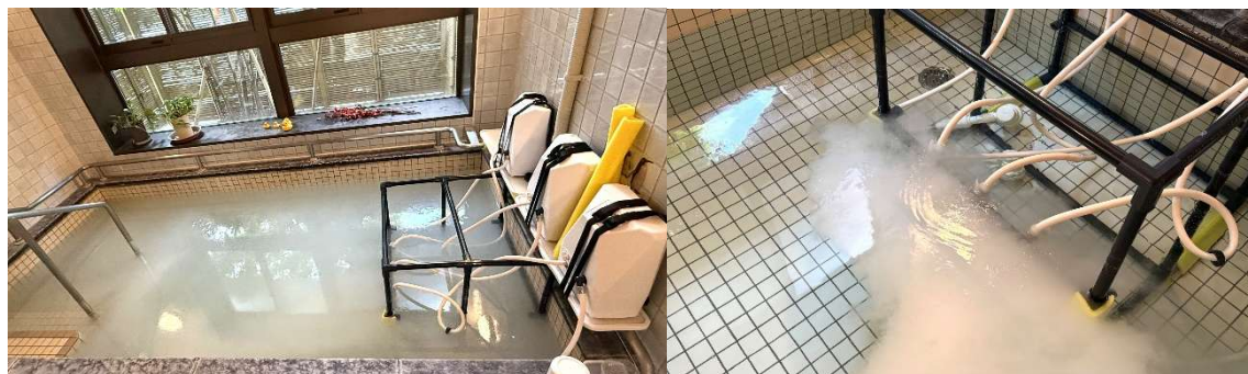
大浴場における検証の様子（ファインバブルにより浴槽内に微細な泡が発生している状態）
